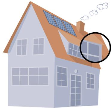
Moderne Fenster sind warm wie die Wand. Voraussetzung sind dicht schließende Rahmen und Wärmeschutzverglasung.
