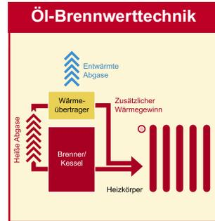
Im Gegensatz zu herkömmlichen Heizkesseln nutzt die Öl-Brennwerttechnik auch die heißen Abgase, die sonst ungenutzt durch den Schornstein entweichen. So wird fast alle Energie genutzt, und dank fortschrittlicher Technik reduziert sich der Energieverbrauch gegenüber dem eines alten Standardkessels um bis zu 30 %.
